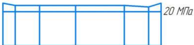
4.4 Сурет – Әр түрлі Р және К кезіндегі тығыздағыштың барлық ұзындығы бойынша байланыс қысымы
